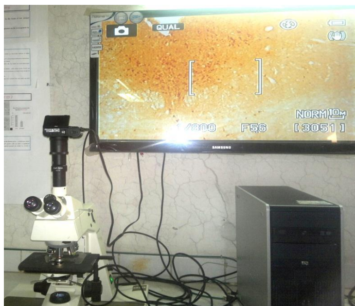
Figure 18: Le système de prise de photo utilisé: caméra connectée à un ordinateur et au microscope.
