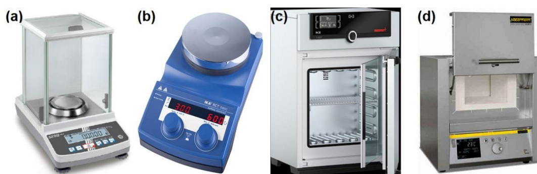
Figure III.2 - (a) Balance KERN ALS 220-4N ; (b) agitateur IKA RCT Basic ; (c) four Memmert UN110 Universal ; (d) four à moufle Nabertherm LT 9/11/B410 .
