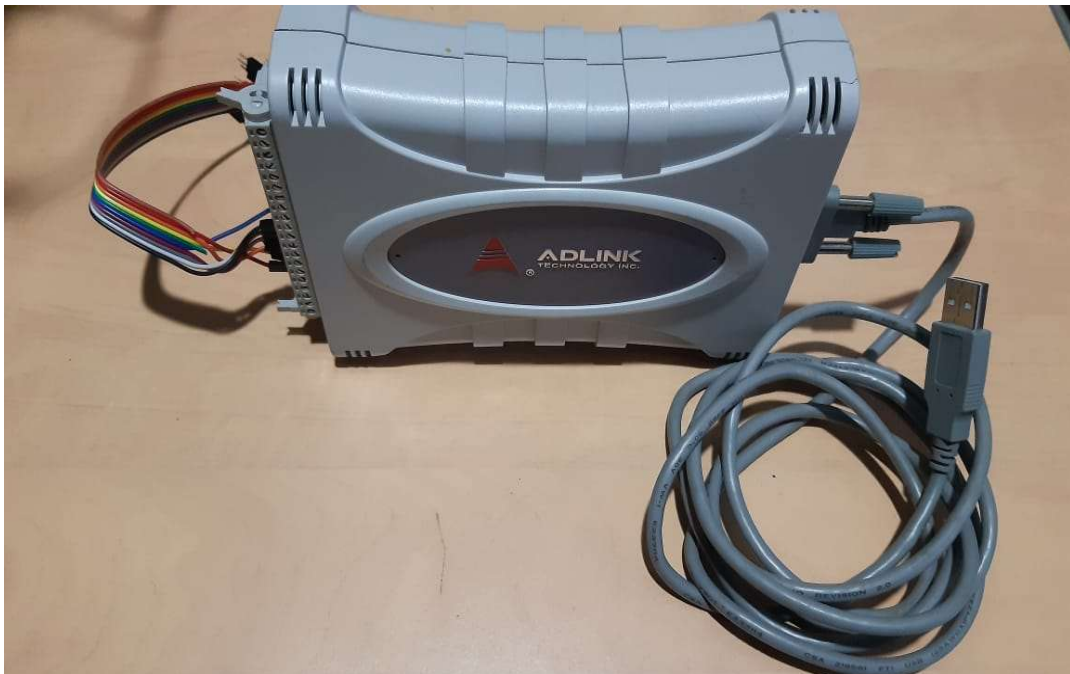
Figure 3-7 Carte d'acquisition de données ADLINK USB-1901
