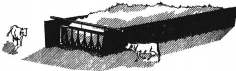
Figure 12: Silo-couloir avec porte de tête pour permettre l'auto-alimentation
