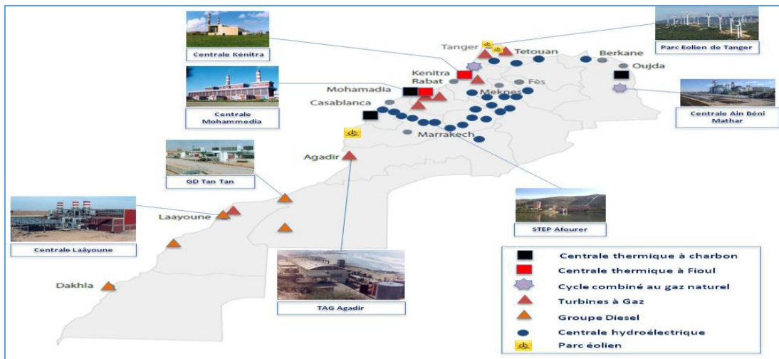
Figure I-2 : Répartition des centrales de production
