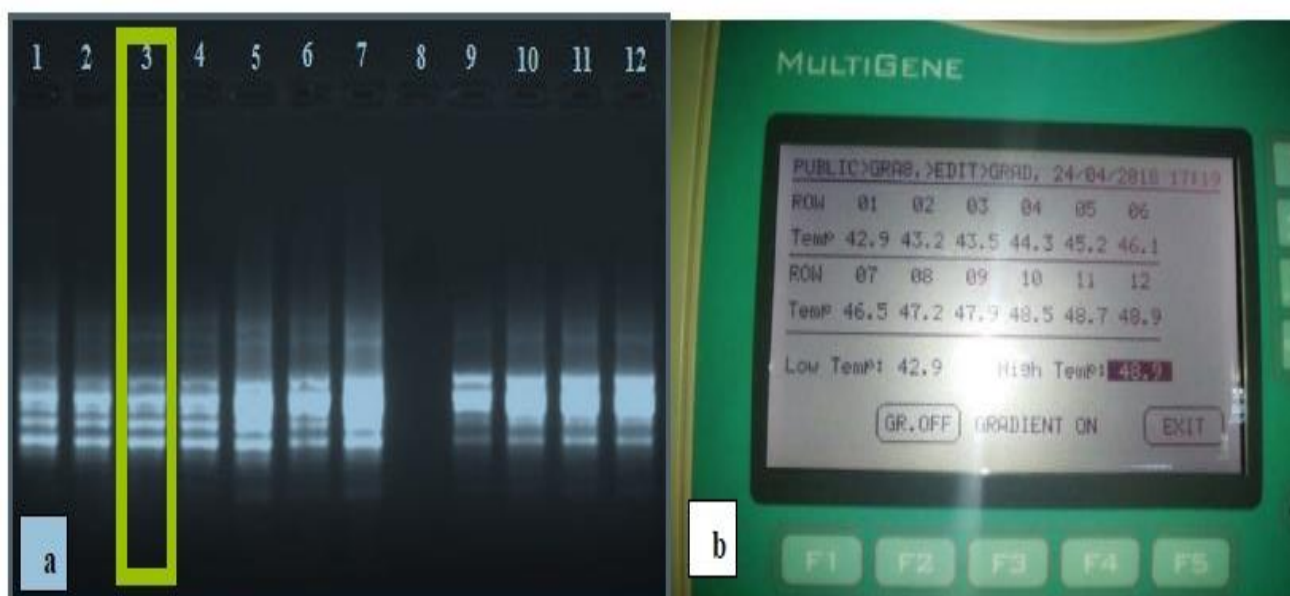
Figure 15 Photo a: Profil d'électrophorèse des 12 répétitions après amplification par PCR à gradient; Photo b: gradient de température en ( ^\circ\text{C} ) affiché par le thermocycleur.
