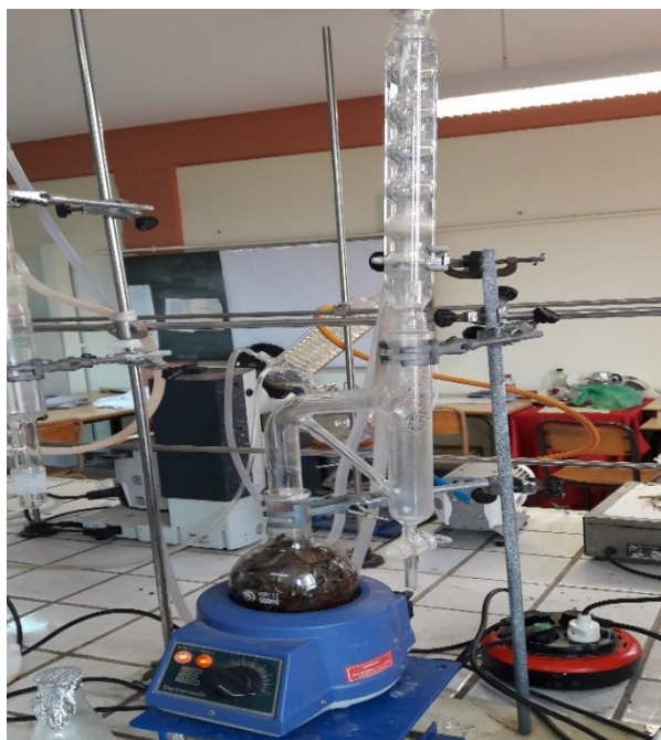
Figure 23 : Montage d'hydrodistillation utilisé.
