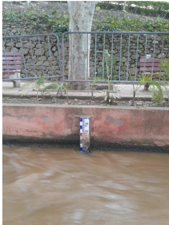
Echelle limnimétrique pour mesure de débit de la source d'Ain Asserdoune
