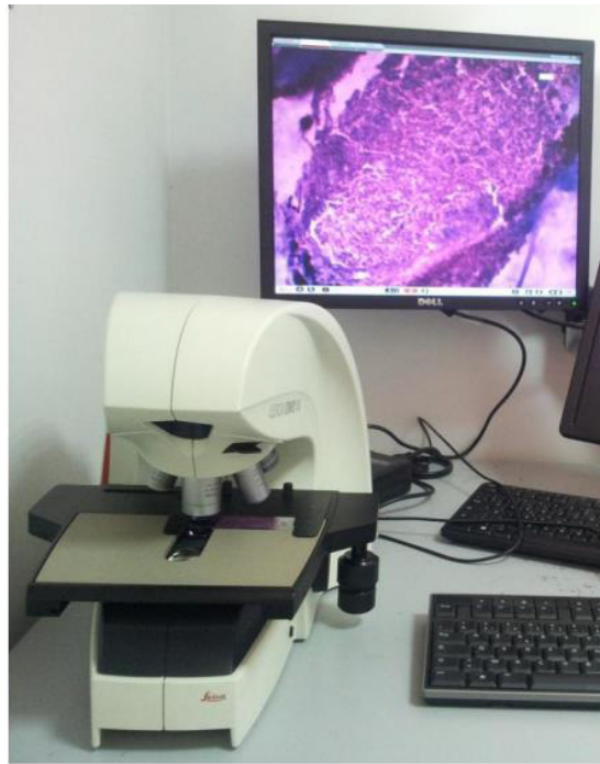
Figure 28: Dispositif de micro-imagerie numérique ; pour la lecture des lames et la prise de photos
