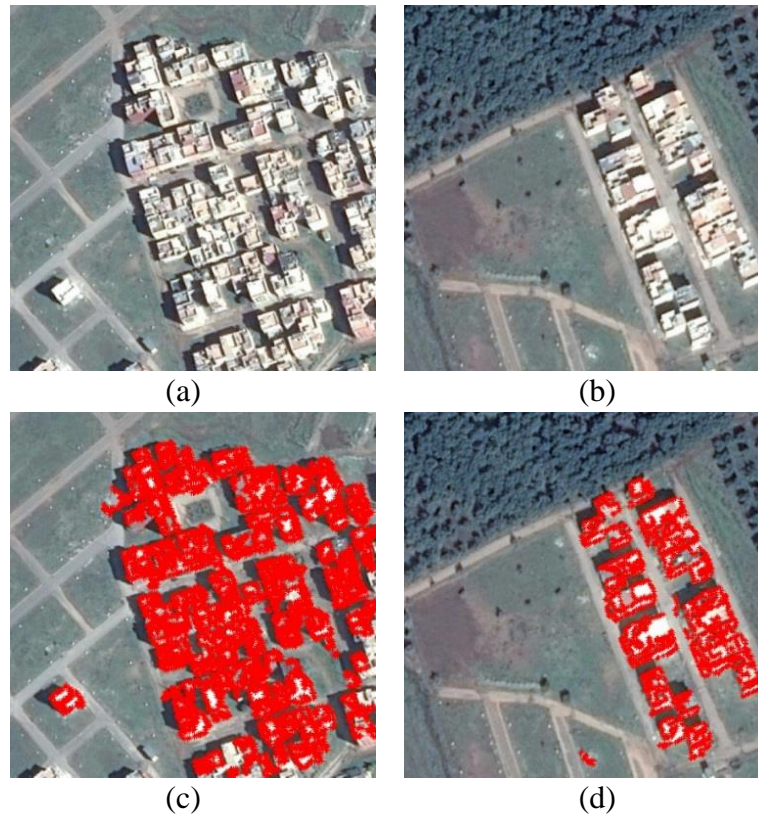
Figure 4-6: (a,b) Images originales. (c,d) Résultats de détection des coins et localisation des bâtiments par CSS.
