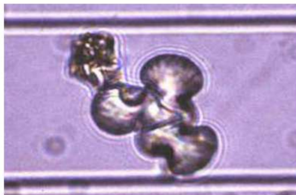
Agrégat de whewellite en "sablier". Dimensions : 20 à 40 microns. pH : 5,8.
