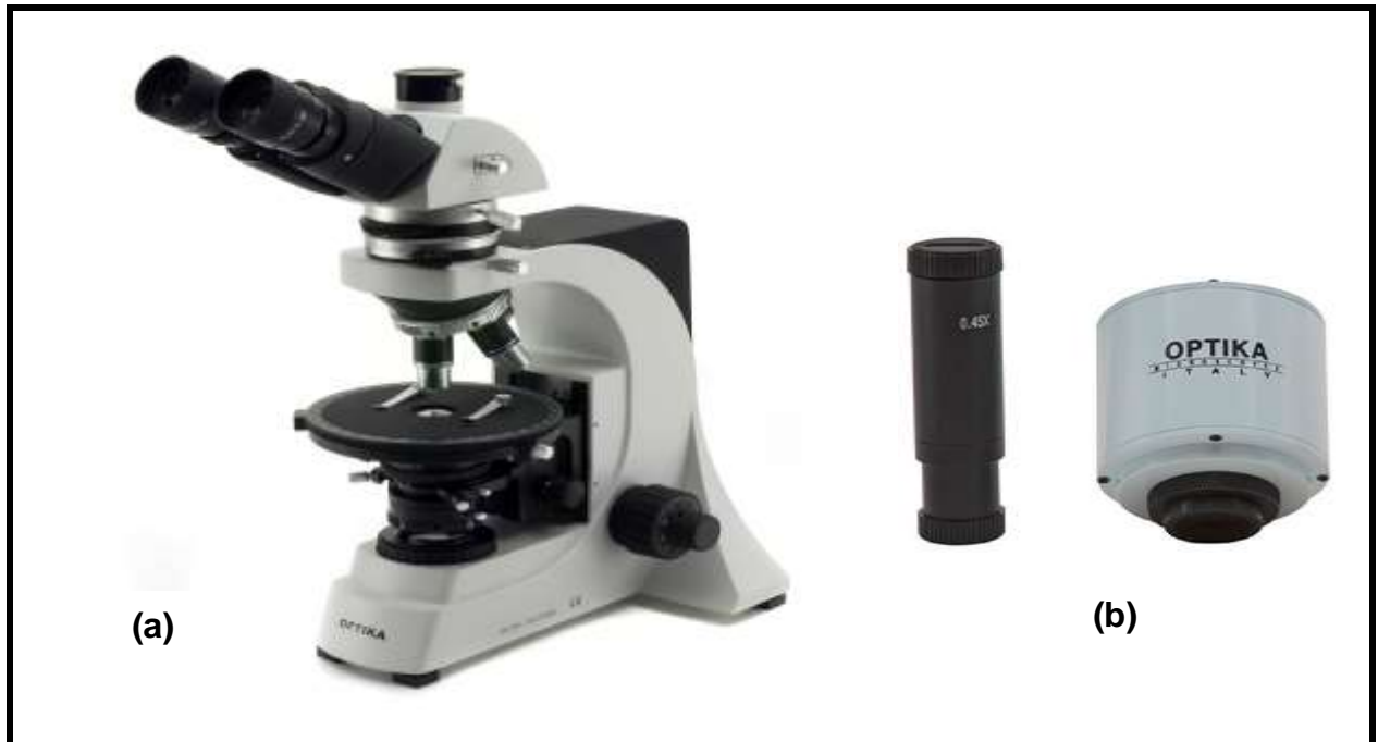
Figure II.2: (a) : Optika Microscope trinoculaire B-383POL avec tête ERGO pour lumière polarisée et illuminateur X-LED et (b) : Caméra Numérique USB - OptiKam 5 Mpixels.
