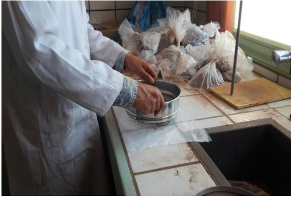
Photo 5: Récupération de la fraction fine ( \leq 2 mm) du compost
