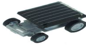
Figure 2.4 : Exemple de plate-forme non holonome (s.d. Image libre de droits).
