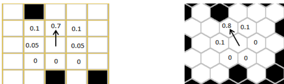
Figure 2.14 : Probabilités de transition vers les états proches dans les deux types de grilles.
