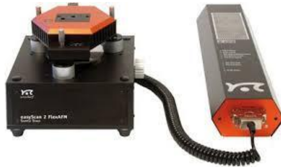
Figure I. 4 : Photo du microscope à force atomique Nanosurf Easyscan 2 AFM
