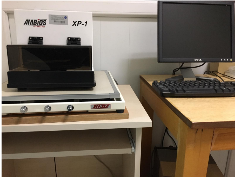
FIGURE II.12 – Profilomètre stylet Ambios XP 1.
