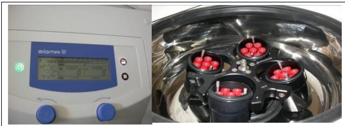
Figure V-5 : Photographie Centrifugeuse Sigma 3-16K avec ses portoirs Vacutainer 5ml.
