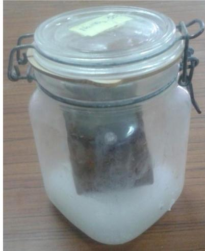
**Figure 55: Bocal expérimental pour déterminer les isothermes de sorption**
