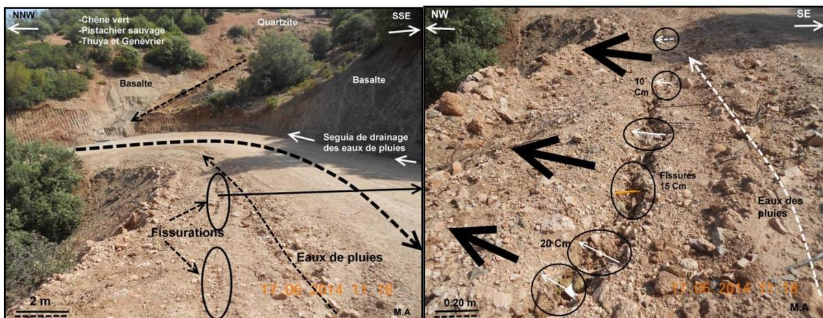
Figure 31: Fissurations de Tension au niveau de la piste durant les périodes arides
