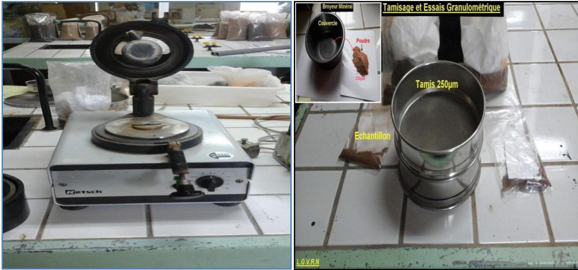
Figure 37: Broyeur minéral et Tamis 250 µm
