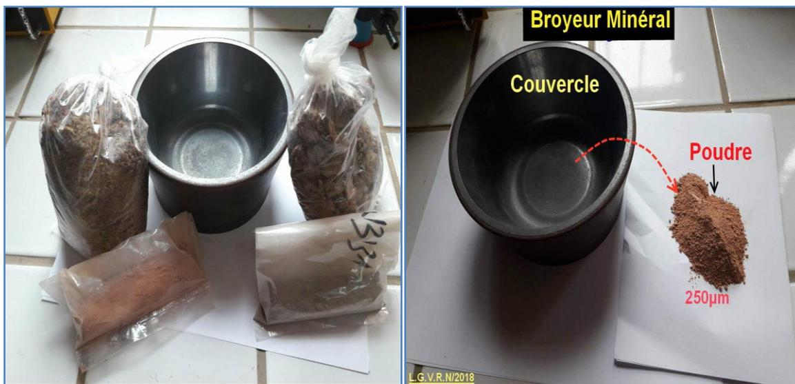
Figure 36: Préparation des échantillons pour analyse minéralogique
