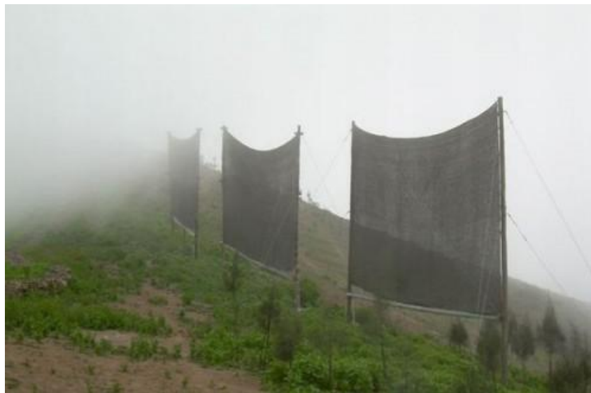
Figure 1. 10. Exemple d'un filet pour collecter l'eau de brouillard. Photo © FogQuest / Tony Makepeace.
