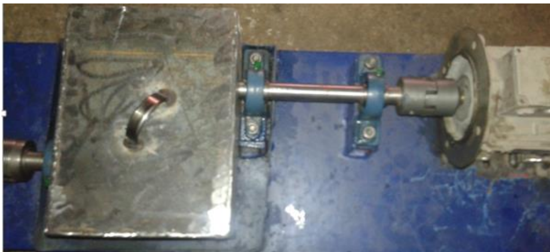
Figure 4.27 Banc d'essai d'un réducteur à deux étages.
