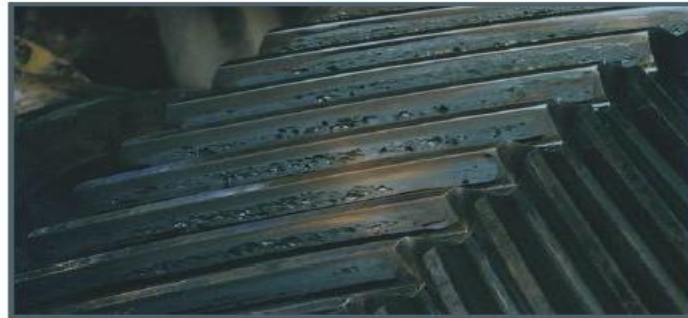
Figure 1.6 Pitting des dentures d'engrenages.
