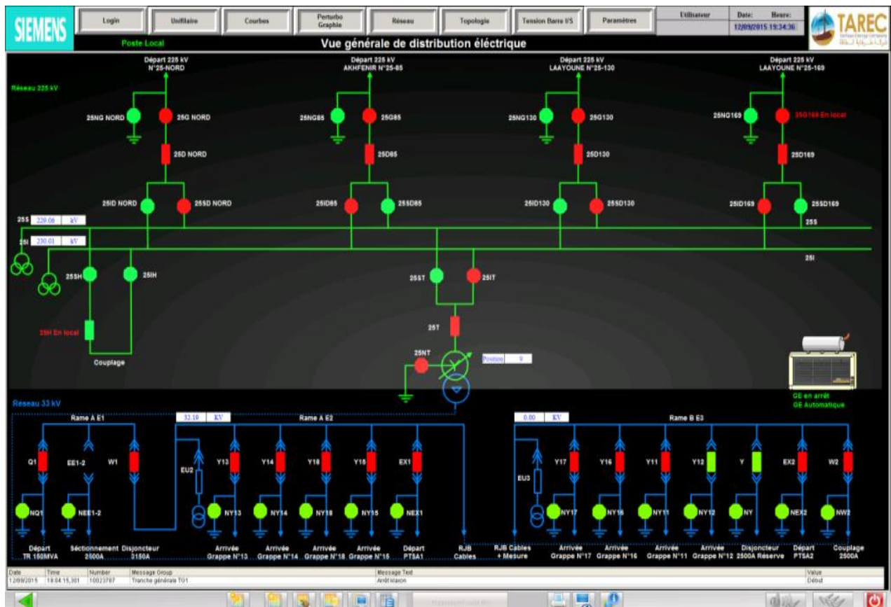
Figure 6. 26: Schéma SCADA du poste d'évacuation Tarfaya
