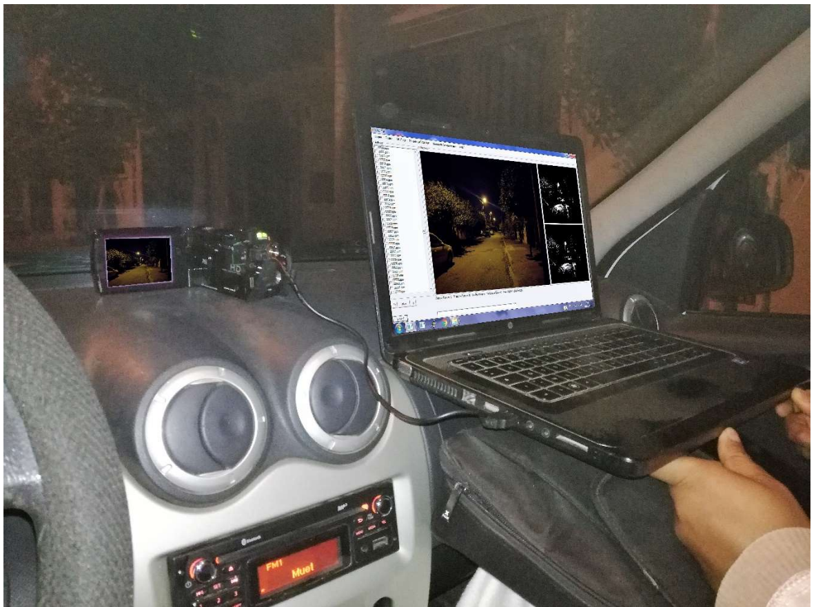
Figure 12: Plateforme de test du Système TSDS embarqué.
