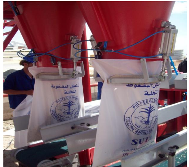
Figure.8 : Machine à ensilage de pulpes de betterave en sacs de 50 Kg sous vide.
