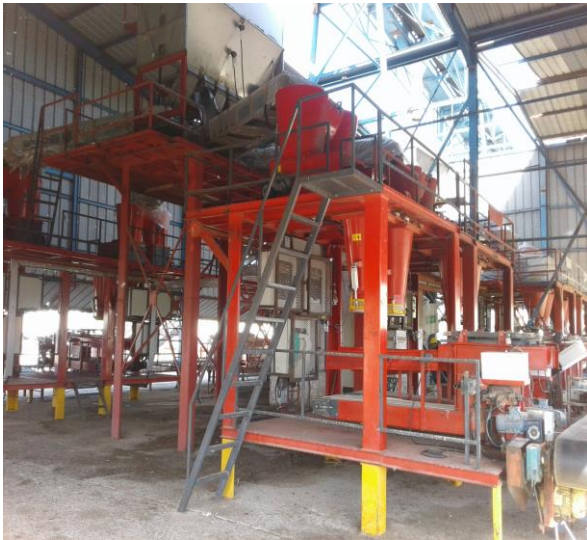
Figure.8 : Machine à ensilage de pulpes de betterave en sacs de 50 Kg sous vide.
