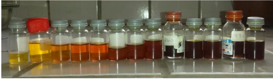
Figure 42 : Photo de l'évolution de la couleur en fonction du temps de torréfaction à 150°C (t=0 min à gauche et 360 min à droite)
