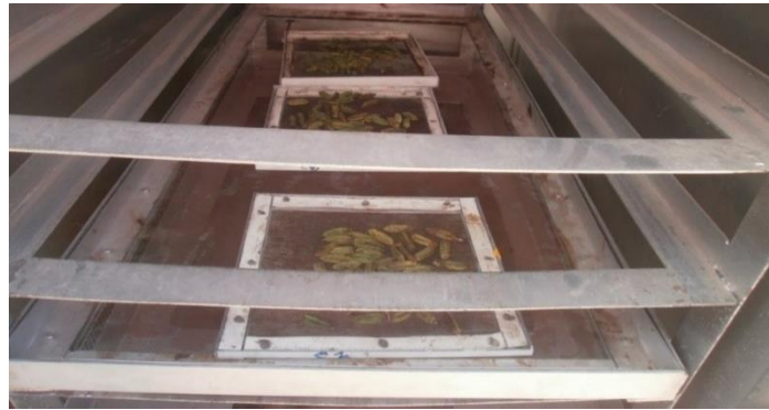
Figure 17 : Dispositif expérimental de séchage solaire (3 claies expérimentales)
