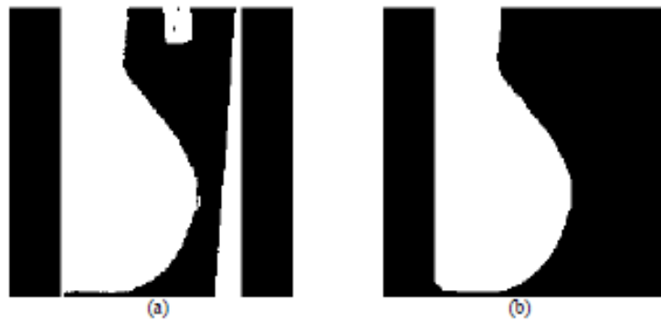
FIGURE 4.7 – Images résultantes avec : a) seuillage T = 0.13 , b) puis opérations morphologiques R=55
