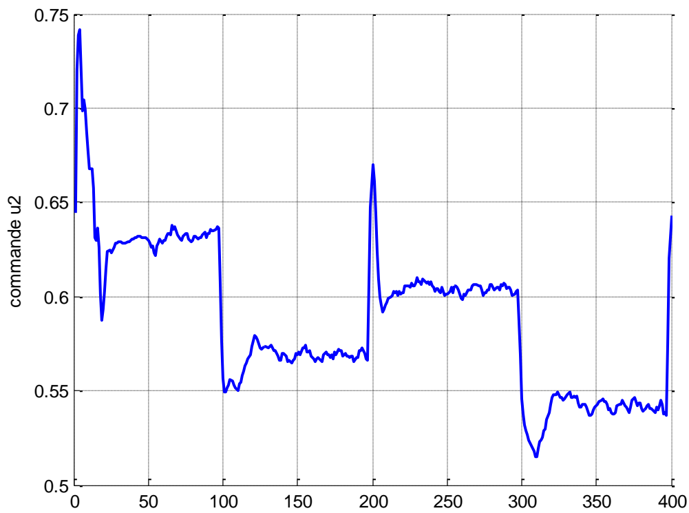
Figure 5.94 Evolution de commande u_2(k) (Débit de refroidissement) de réacteur chimique en présence des perturbations
