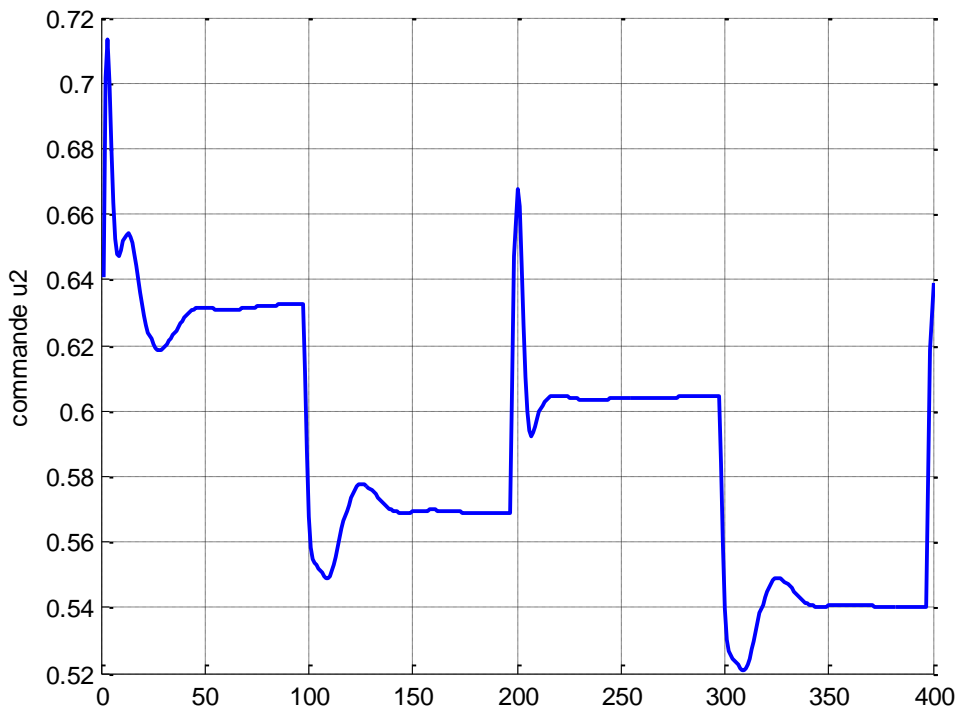
Figure 5.72 Evolution de commande u_2(k) (Débit de refroidissement) de réacteur chimique en absence des perturbations
