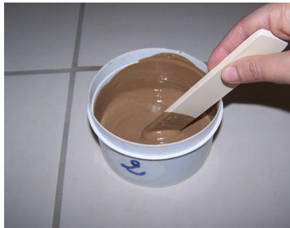
Figure 6.2 Préparation de la pâte saturée.
