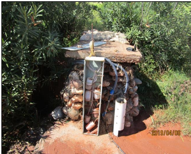
Photos 9: Composants de l'échantillonneur (RSS) automatique
