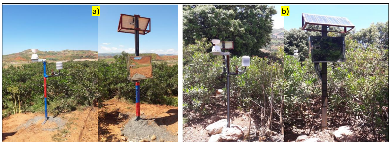
Photos 2: Stations pluviométriques et enregistreurs des données installées au exutoires des bassins expérimentaux de Talhiant (a) et Mougeryberdan (b).
