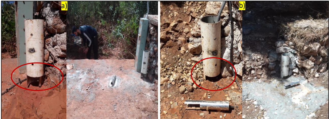
Photos 3: Présentations des capteurs des hauteurs d'eau dans les deux bassins expérimentaux de Talhiant (a) et Mougeryberdan (b)
