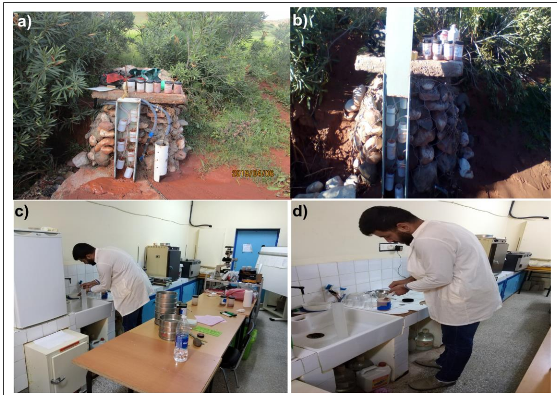
Planches des photos 1: Collecte des échantillons après chaque événement (a et b), et analyse et extraction de la concentration des sédiments au laboratoire (c et d)
