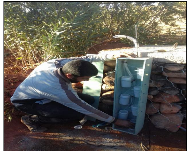
Photos 9: Composants de l'échantillonneur (RSS) automatique
