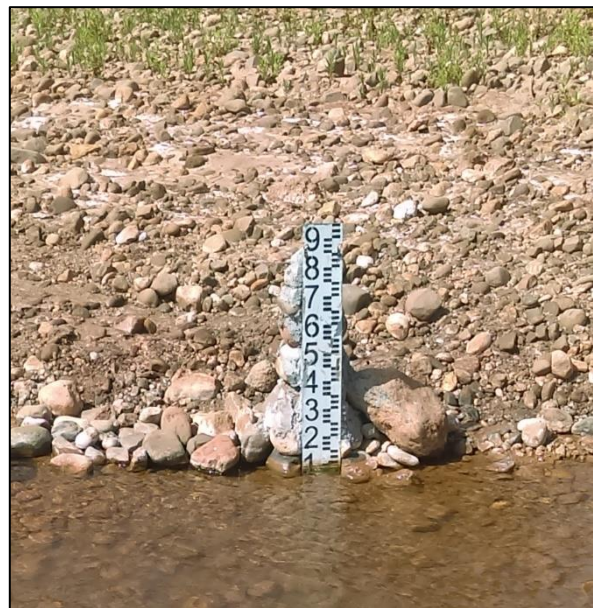
Figure 10-6 : Echelle limnimétrique installée sur l'oued de Srou et sur l'affluent Assif N'douma
