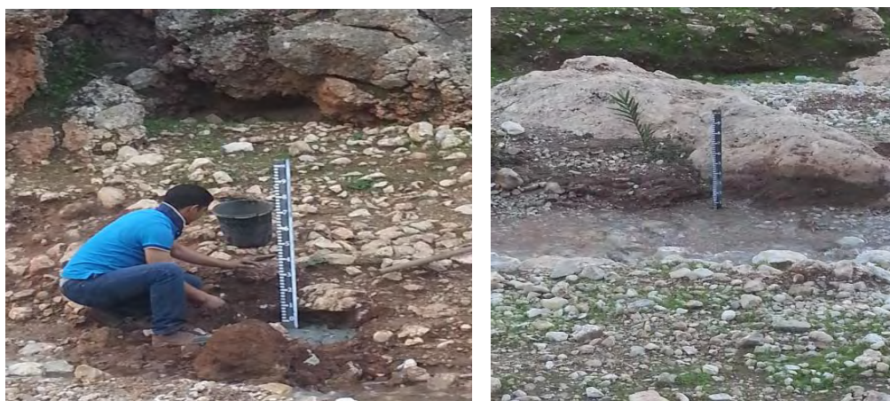
Planche photos 5.1 : Echelle amont et aval – l'exemple de l'Oued Echkounda(Sid Chamià).
