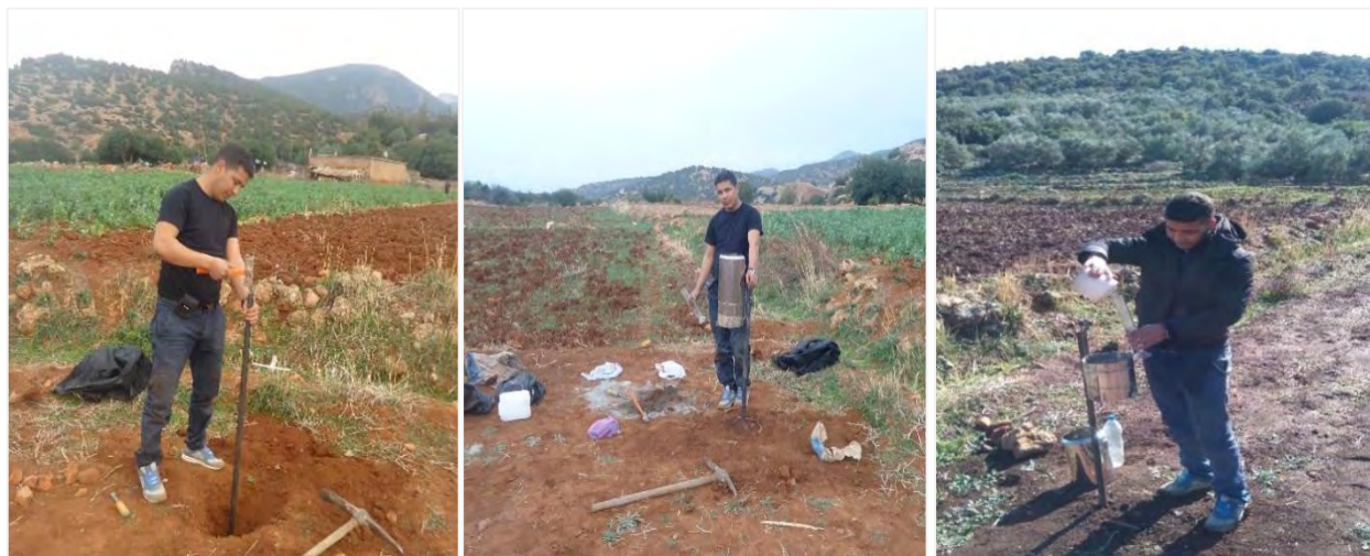
Planche photos 3.1 : Travaux d'équipement de l'oued Ikkour et l'installation du pluviomètre.
