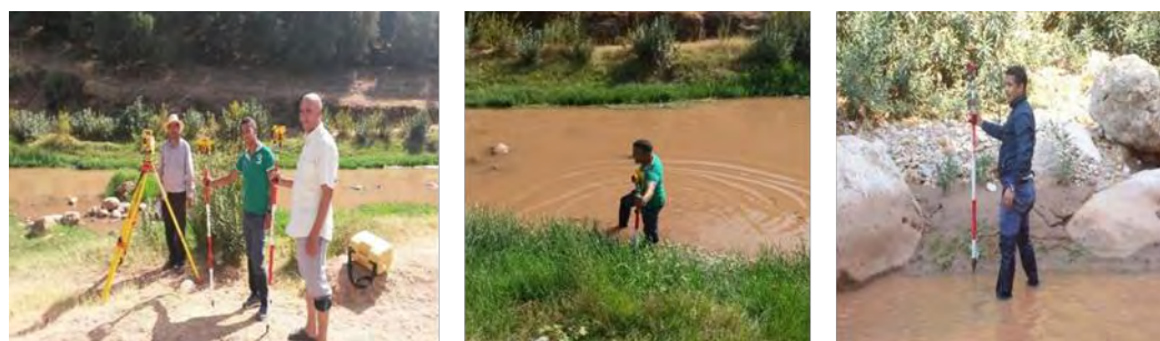
Planche photos 5.2 : Levés de profils en travers par tachéomètres.
