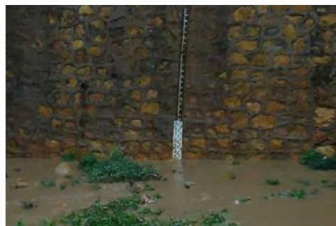
Photo 5.1 : Niveau d'eau à l'échelle aval de l'oued Ikkour.
