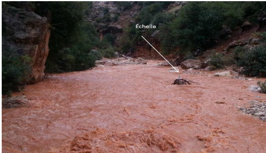
Photo 5.3 : Ecoulement pour une cote de l'ordre de 30cm sur le site de mesure de Hançala.
