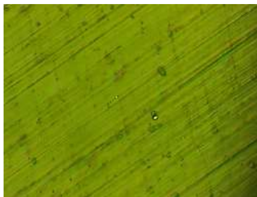
Figure 45 - Micrographie optique de l'acier inoxydable Hastelloy C2000 après traitement thermique à 800°C, attaqué avec de l'eau régale, 100 minutes après la trempe.
