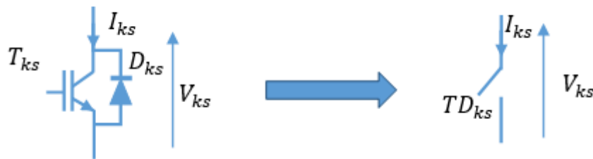
Figure 2. 11: Interrupteur bidirectionnel équivalent de la paire Transistor – diode.
