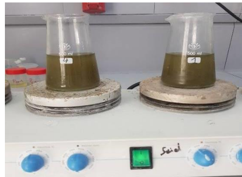
Figure. Dispositif du chauffage des boues
