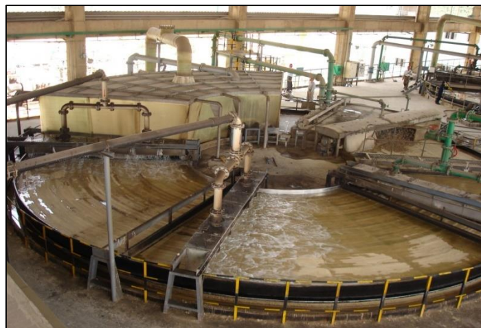
Figure 5. Filtre rotatif de l'acide phosphorique au site Jorf Lasfar
