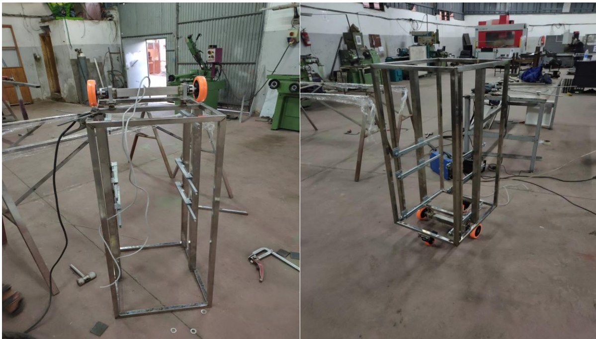
Figure : conception du système de mouvements (ce système n'a pas marché à cause du poids)
