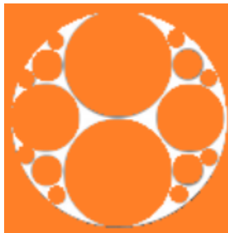
Figure II- 7: Exemple d'une antenne fractale circulaire à l'itération 4
