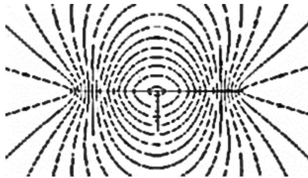
Figure I- 3: Exemple des lignes de champs générées par une antenne demi-onde
