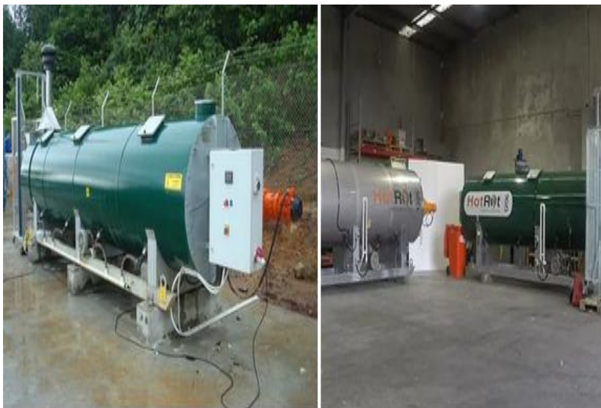
Figure 1. 3: Composteur rotatif à bras mécanique de HOTROT [72]
