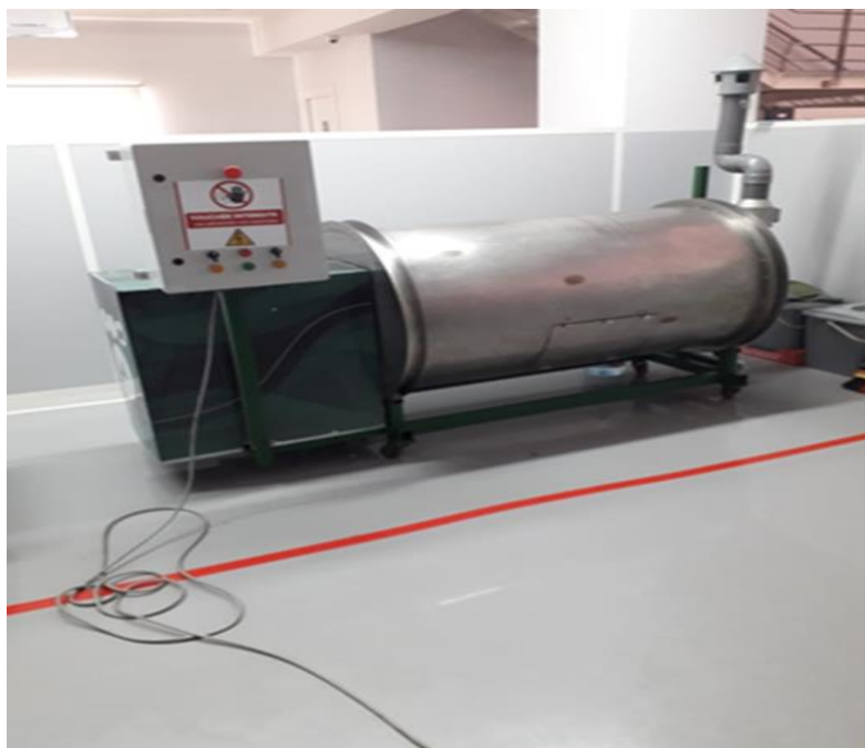
Figure 4.17: Prototype Réel de composteur rotatif à tambour
