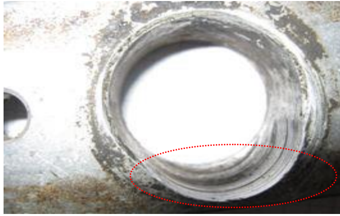
Figure 2. 5: Palier d'usure défaillant.
