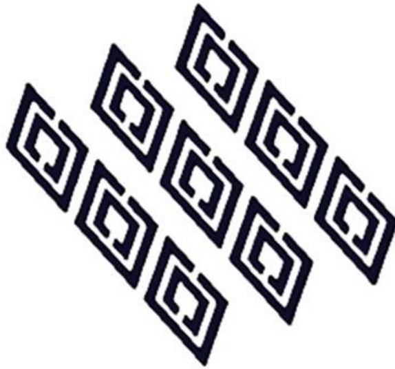
Figure IV-28: SRR proposés par Pendry pour avoir un milieu à perméabilité négative
