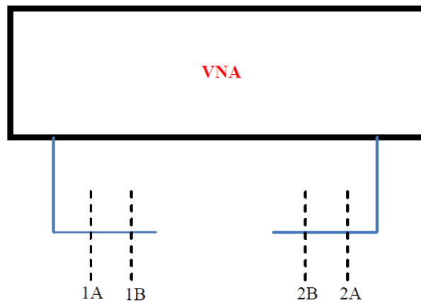
Figure I-13 : Plan de référence dans la mesure de l'analyseur de réseau vectoriel (VNA) [25]
