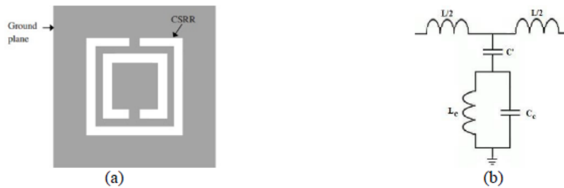
Figure IV-20: (a) Géométrie d'une cellule unitaire CSRR, (b) Circuit équivalent à éléments localisés du CSRR
