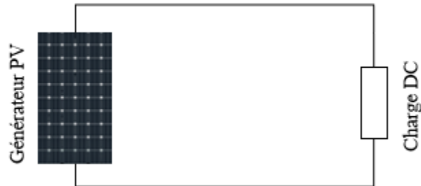
Figure 27 : Connexion directe entre la charge et le générateur PV
