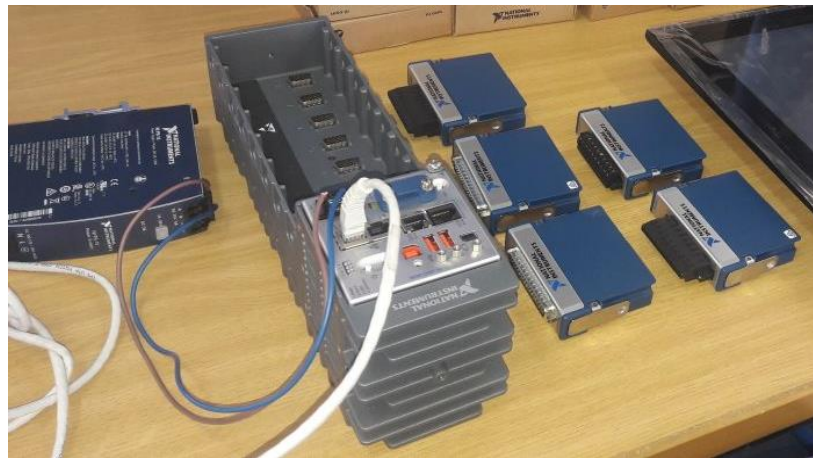
Figure 100 : CompactRio, son alimentation et les modules d'entrée et de sortie
