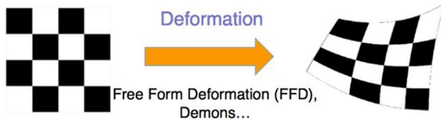
Figure 48: principe de la fusion élastique, selon Crevoisier de l'université de Lille
