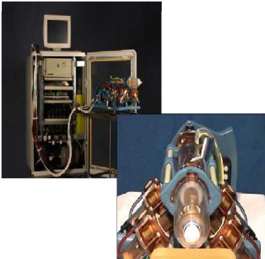
Figure 15 : Robot de ponction prostatique sous IRM (John Hopkins University) [64].
