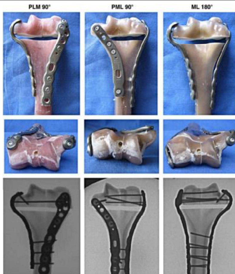
Fig.27 : Différentes configurations d'ostéosyntheses. Les deux premières colonnes présentent un montage perpendiculaire, la dernière colonne un montage parallèle
