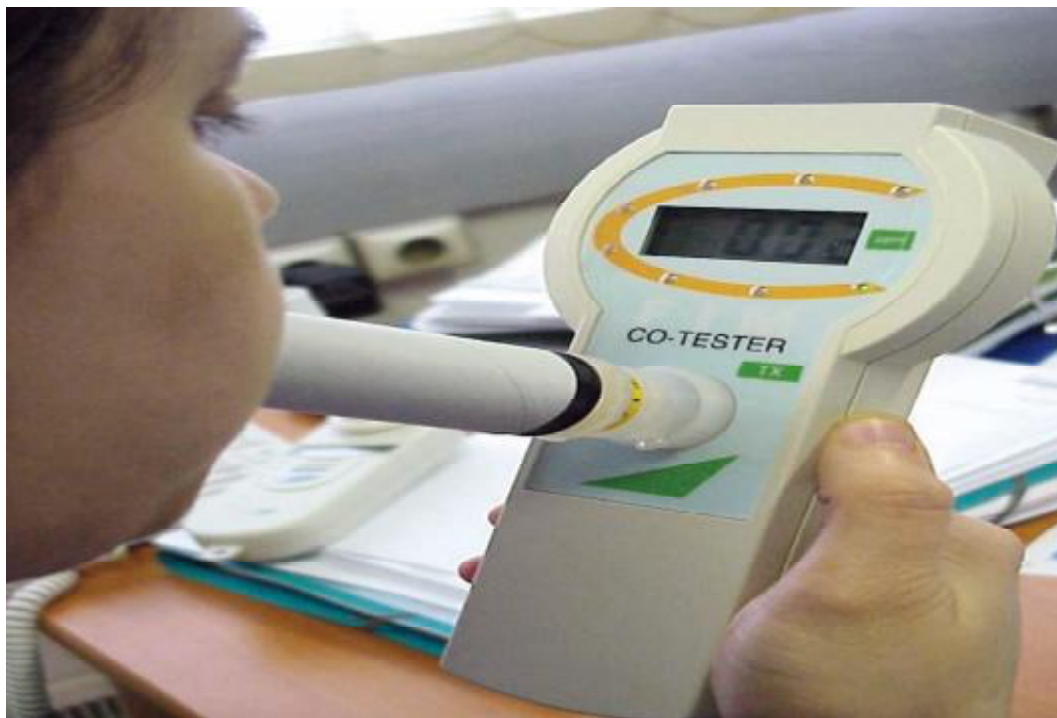
Figure 6: Mesure du taux de CO expiré à l'aide d'un analyseur numérique de CO [43]
