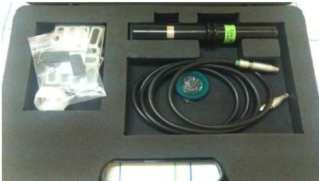
Figure 44 : sonde d'UBM de notre service
