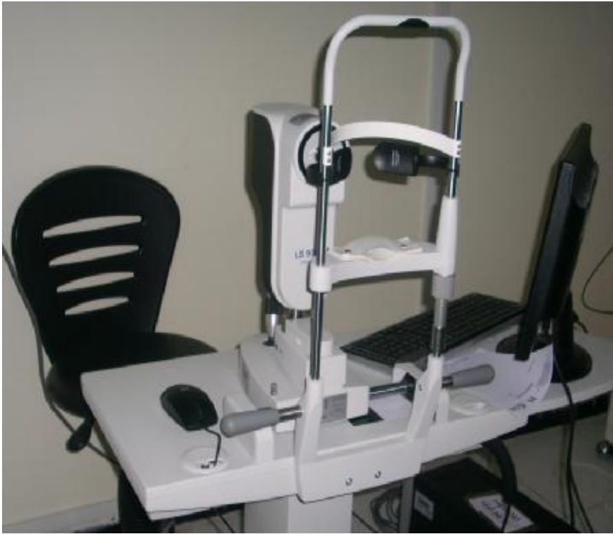
Figure 43 : Biomètre non contact LS900 de chez HAAG-STREIT. (image du service)
