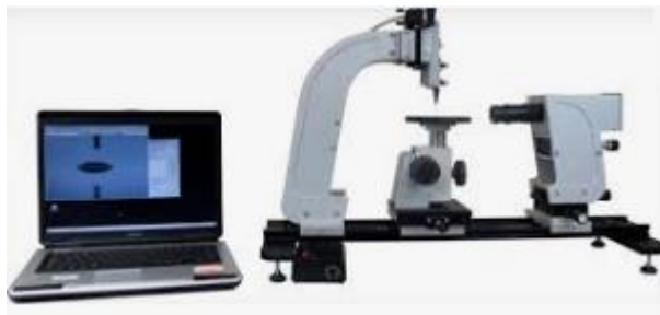
Figure 22: GONIOMETRE (GBX, France) (dispositif) de la mesure de l'angle de contact.
