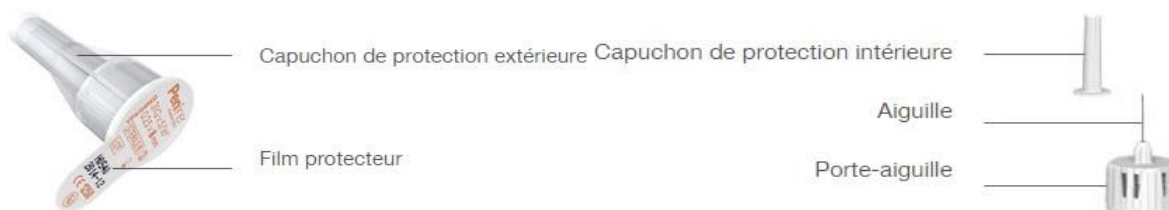
Figure 16: Composition d'une aiguille d'un stylo injecteur [66]
