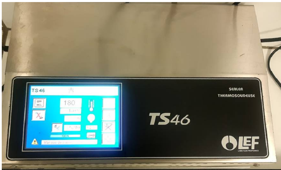
Figure 15: Thermo-soudeuse TS46IVSB-LEF utilisée pour le scellage
