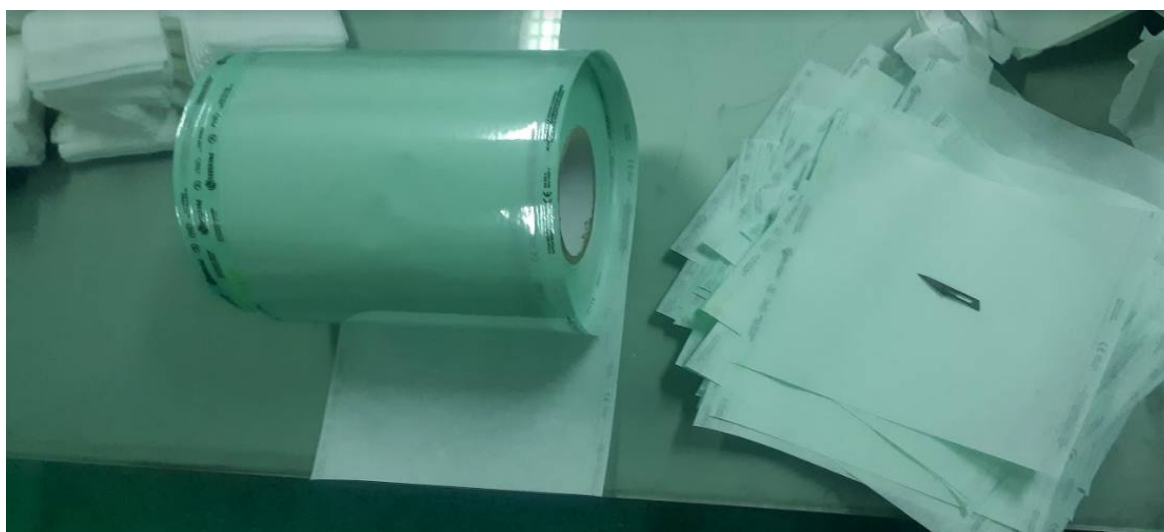
Figure 16: photo montrant la coupure de la gaine de conditionnement en morceaux de 20 cm.
