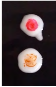
Figure 53: Phase intermédiaire de la détermination du sens de l'émulsion
