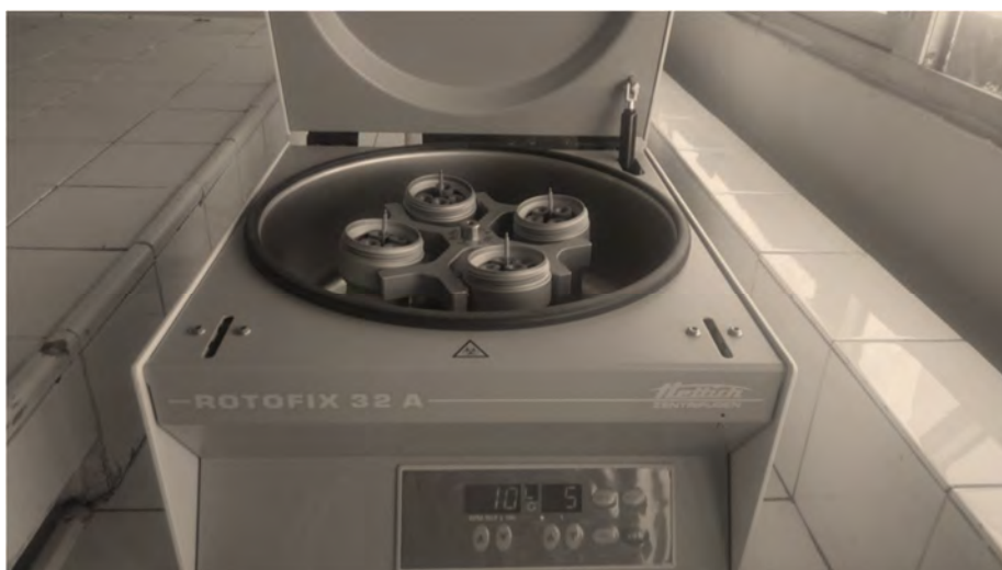
Figure 36: Photo la centrifugation des tubes à une vitesse de 1000 tr/min pendant une durée de 5 minutes
