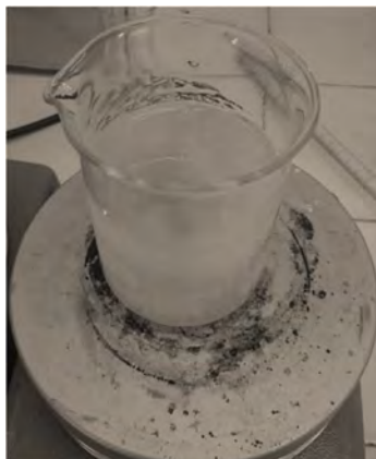
Figure 46: Solution de carbopol 1% obtenue après agitation
