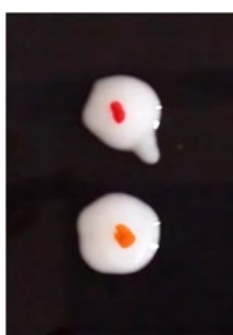
Figure 52: Phase initiale de la détermination du sens de l'émulsion
