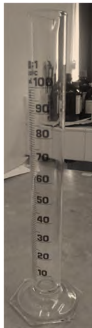
Figure 45: Photo de l'éprouvette de 100 ml utilisée pour prélever l'eau
