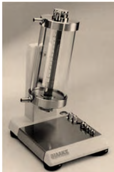
Figure 16: Viscosimètre à chute de bille (Höppler)
