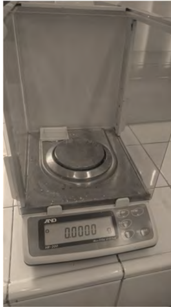
Figure 44: Photo de la balance utilisée pour mesurer la quantité en carbopol
