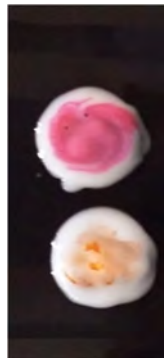
Figure 53: Phase intermédiaire de la détermination du sens de l'émulsion
