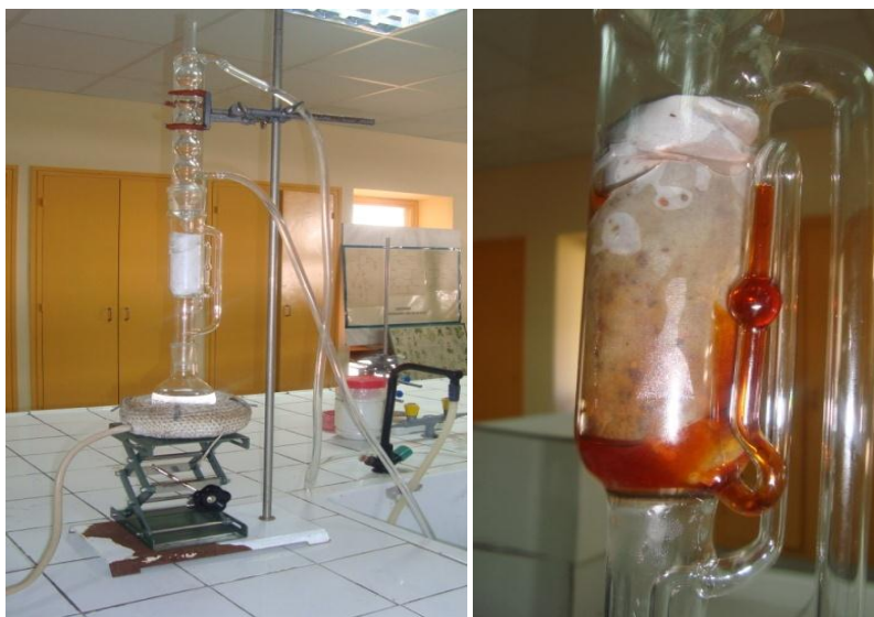
Figures 43 : Soxhlet en cours d'extraction
