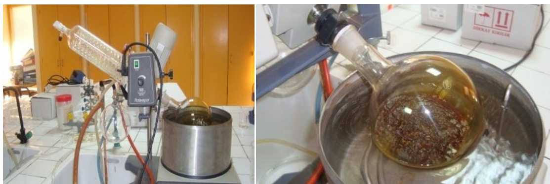
Figures 45 : Extrait chloroformique en évaporation dans un évaporateur rotatif
