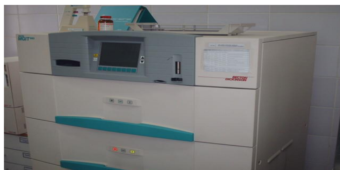
Figure 16 : INCUBATION DES MILIEUX DANS LE MGIT Bactec 960, service de Microbiologie, HMIMV RABAT 2010
