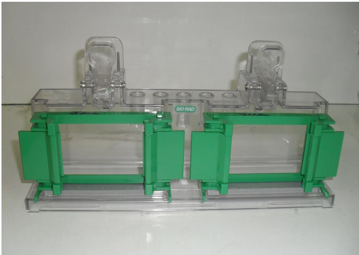
Figure 4. Dispositif de polymérisation du gel de polyacrylamide (BIO-RAD)
